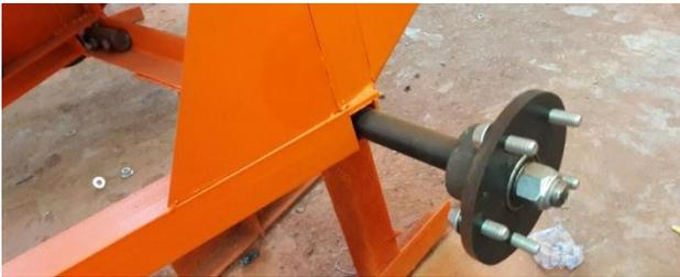
**Semi Eje desmontable 02 pzas.**
